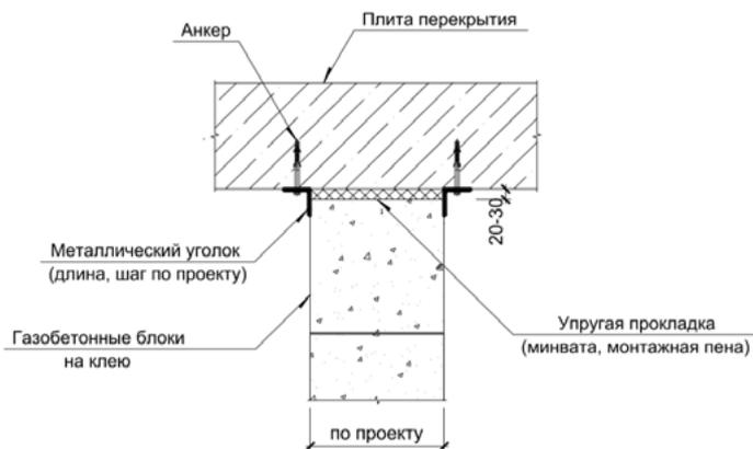
Когда требуется очень высокая или протяжённая перегородка небольшой толщины, может понадобиться её усиление. Производите усиление следующим образом:
