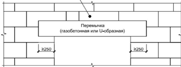
Если длина проёма в свету более 1,25 м, устанавливайте временные опоры под перемычку на время укладки верхнего ряда блоков.
