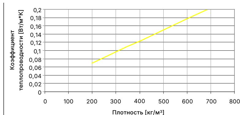
График зависимости теплопроводности от плотности для газобетона ISTKULT при равновесной влажности 6%.
