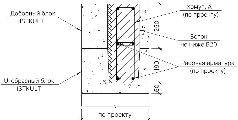
В кладке стен под оконными проемами имеет место скачкообразное изменение нагрузок. В целях предотвращения появления трещин на этом уровне рекомендуется укладка арматуры в заполненных раствором углублениях (два стержня Ø6 мм). Стержни должны заходить за пределы проема минимум на 50 см с каждой стороны. Отдельные примеры устройства перемычек показаны на чертежах на следующей странице.
