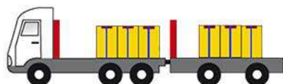
Сцепка тягач + полуприцеп при полной незагрузке Каждый ряд паллет закреплен ремнями с уголками. Размещение груза производится с учетом допустимой нагрузки на оси.
