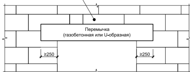
Газобетонные блоки на клею (шов 1-3 мм)
