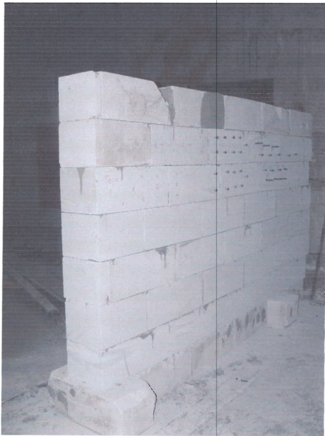
Рис. 1.1 Общий вид фрагмента стены из ячеистобетонных блоков (габариты стены L \times B \times H - 3.25 \times 0.3 \times 2.0 м).
