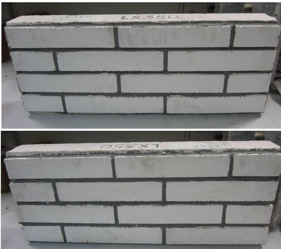
Фото 3. Фрагменты стеновых панелей с наклеенной декоративной плиткой YTONG Décor окрашенной фасадной силиконовой краской LX 350
