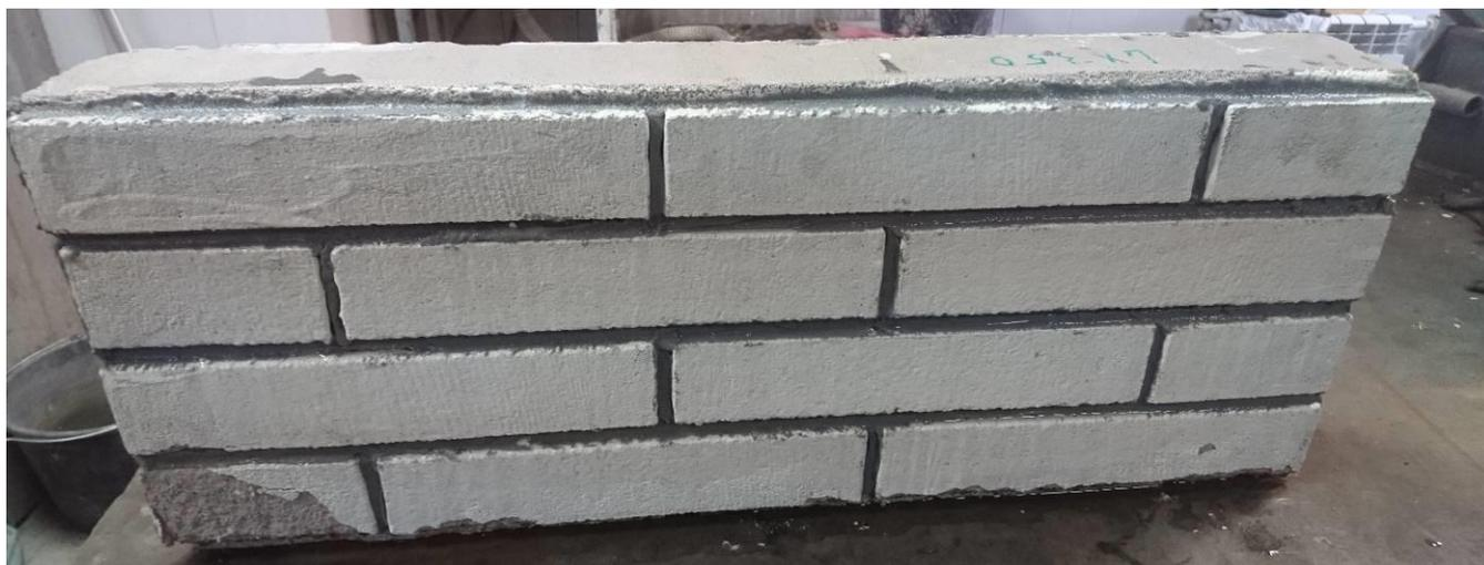
Фото 6. Внешний вид декоративной плитки YTONG D'ecor наклеенной на фрагмент стеновой панели и окрашенной фасадной силиконовой краской LX 350 после 23 –х циклов замораживания оттаивания
