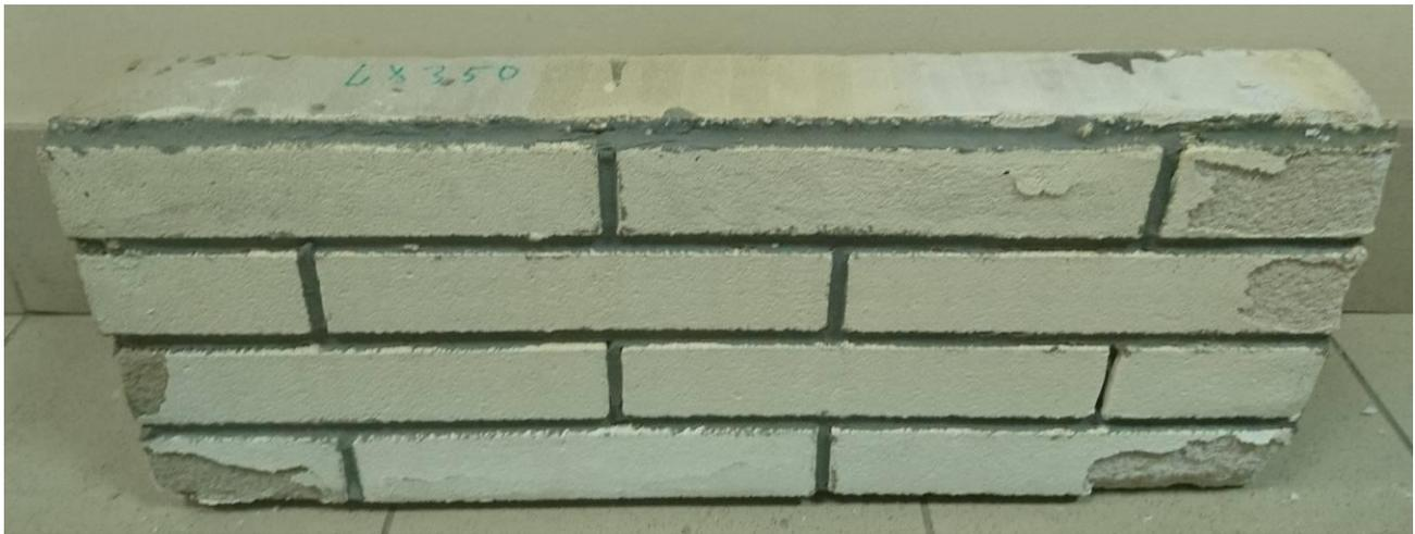
Фото 7. Внешний вид декоративной плитки YTONG Décor наклеенной на фрагмент стеновой панели и окрашенной фасадной силиконовой краской LX 350 после 35 –ти циклов замораживания оттаивания
