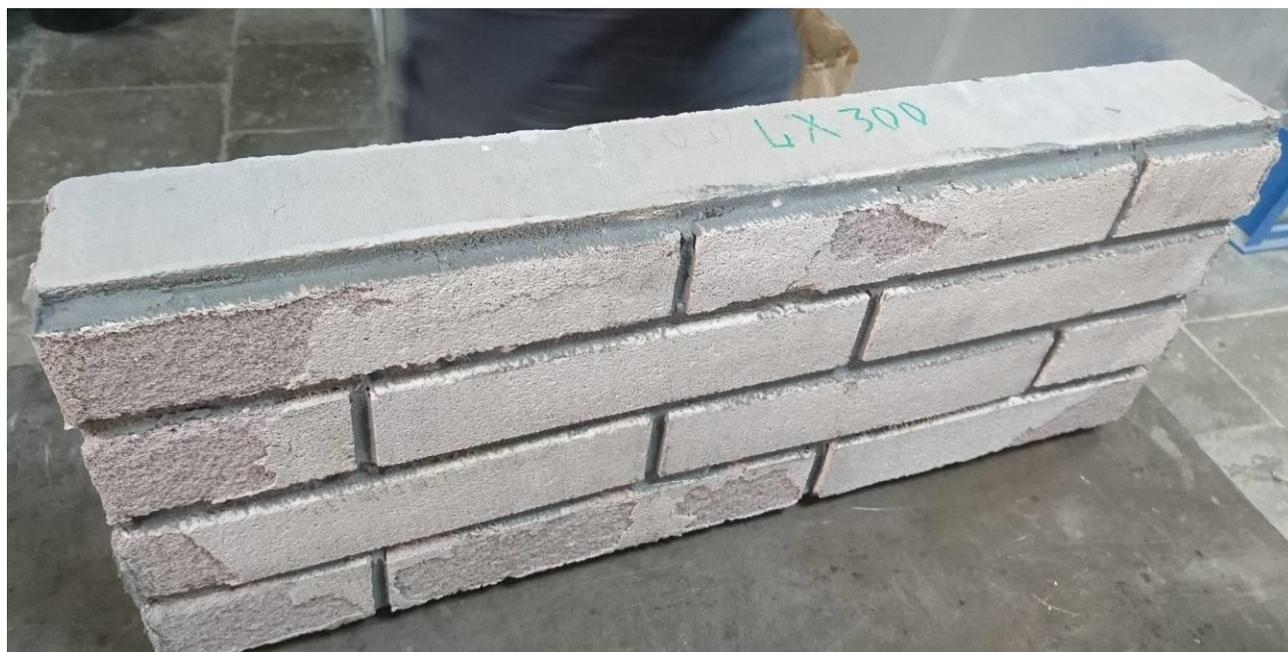
Фото 5. Внешний вид декоративной плитки YTONG D'ecor наклеенной на фрагмент стеновой панели и окрашенной фасадной силиконовой краской LX 300 после 16 –ти циклов замораживания оттаивания
